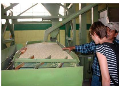
5. Una técnica observa la limpieza mecanizada de semillas de maíz ICTA B-9<sup>ACP</sup>.
