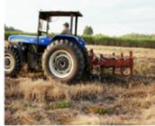
**Escarificador para labranza profunda en frijoles y fertilización en bandas localizadas**
