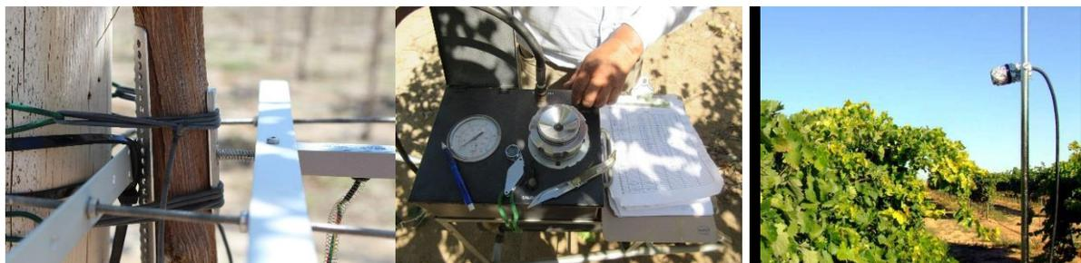
Figura 24. Monitoreo estado hídrico interno de los cultivos, dendrómetro de tronco, cámara de presión tipo Scholander y sensor de temperatura infrarroja.
