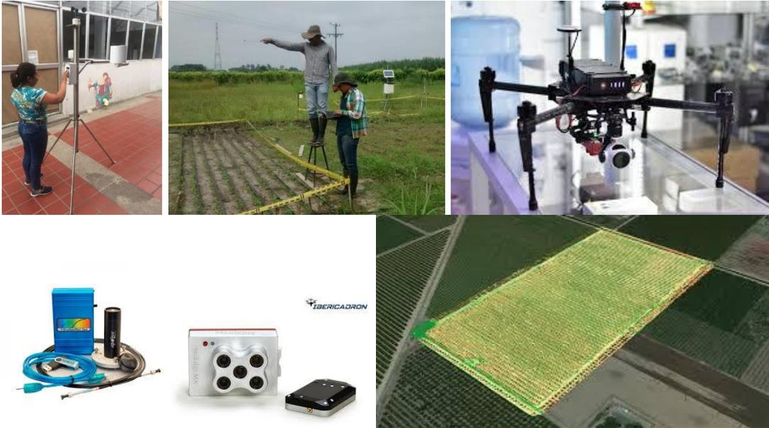
Figura 1. Instrumentación para la determinación de la demanda ambiental y coeficientes de cultivo para el riego de cultivos en parcelas experimentales.
