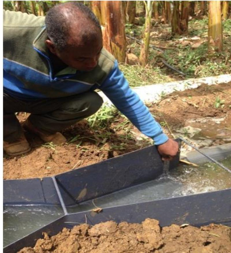
**Fotografía 1.** Ejemplos aforador de fabricación local en uso para la medición del caudal en República Dominicana.
