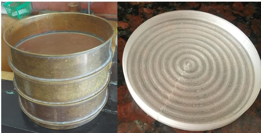
**Figura 2.** Set de tamices y placa de anillos concéntricos para aislamiento y conteo de esporas.
