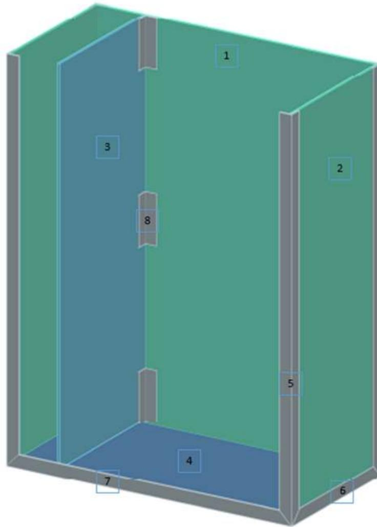
Figura 3. Detalle de ubicación de los materiales de construcción del biorreactor. Las referencias están citadas arriba. No se muestra la placa frontal a fin de visualizar el interior del mismo
