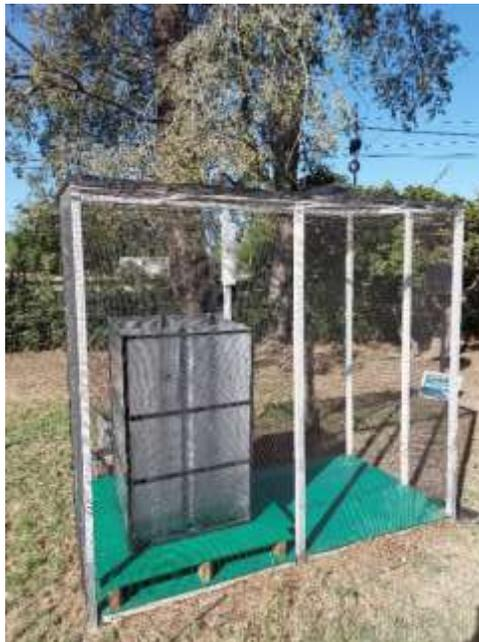
Figura 12. En esta imagen se puede observar la estructura metálica con protección de malla antigranizo, la base del biorreactor y el biorreactor de doble celda
