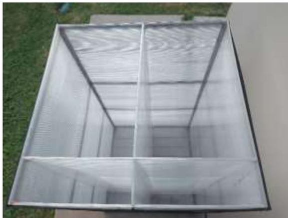
Figura 1. Biorreactor de doble celda.
