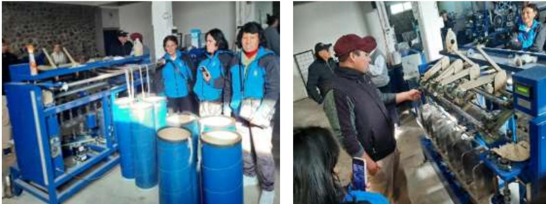
**Foto 26.** La máquina de armado de mecha y luego el posterior hilado.
