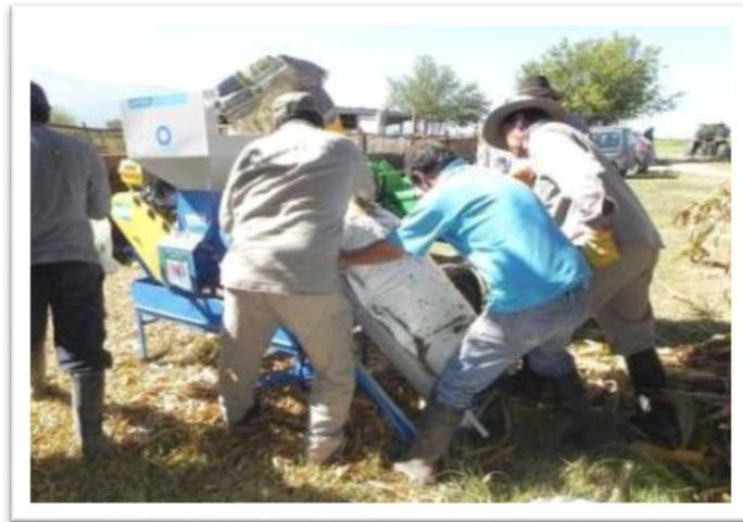
**Figura 6.** Picadora-embutidora de Mini Silo Bolsa. **Foto:** Tomás. A. Vera
