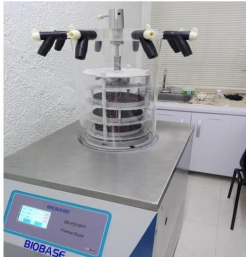
Figura 4. Encapsulación por freeze drying.
