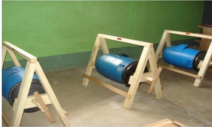
Figura 13. Prototipo F2. Cilindro de plástico de grado alimentario
