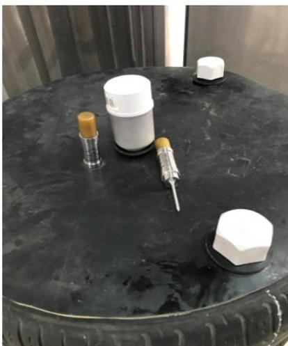
Figura 30. Tapa de caucho con lona que soporta la válvula check en su centro. Vista de sensores de temperatura.
